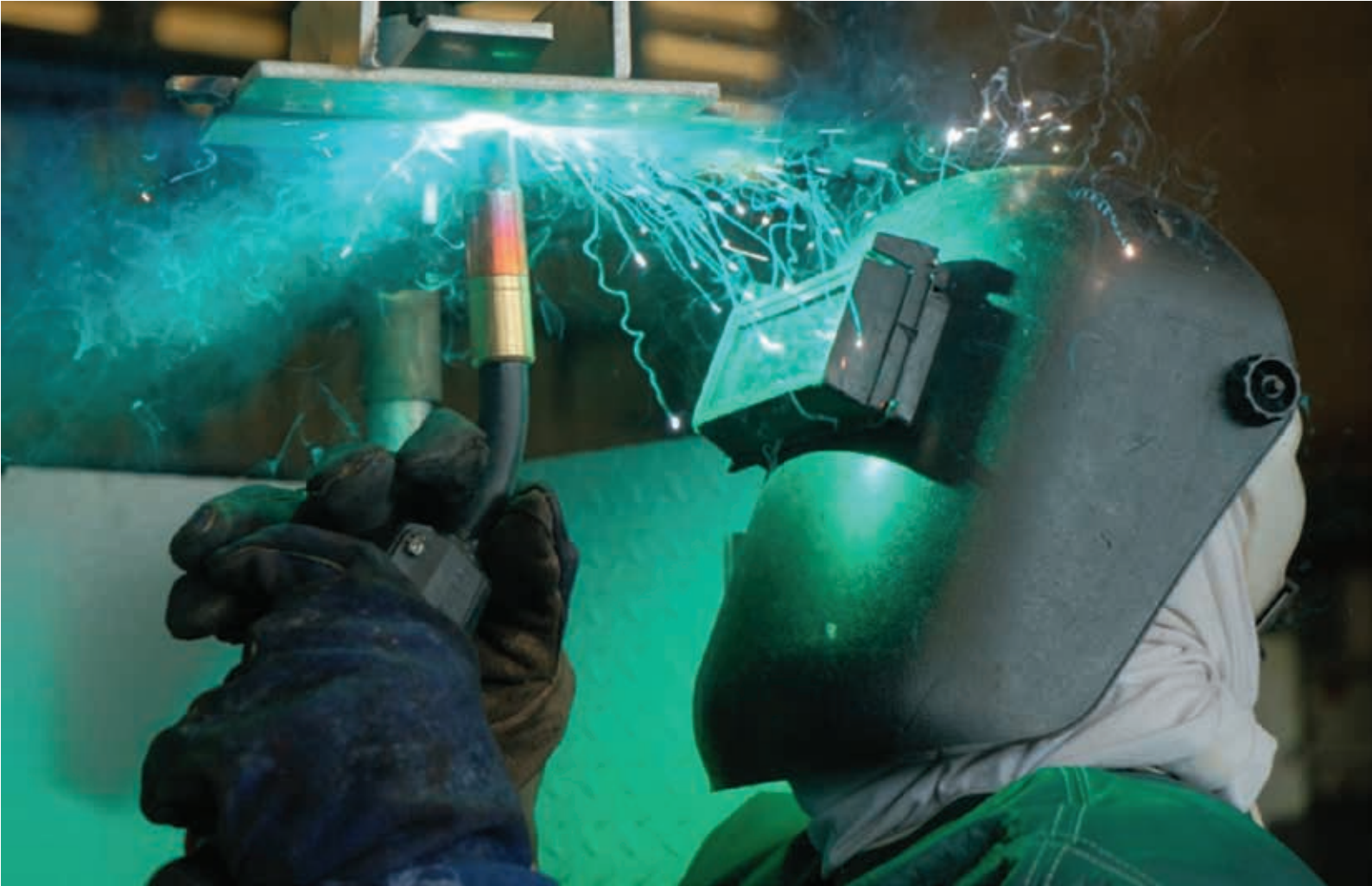
รูปการทดสอบฝีมือช่างเชื่อมของ อร. ในท่าเหนือศีรษะ (4G) กระบวนการเชื่อม FCAW
