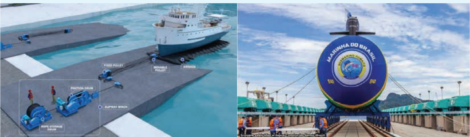
รูปที่ 3 แสดงปั้นจั่นชนิด Slipway และ Shiplift หรือ Sycrolift
