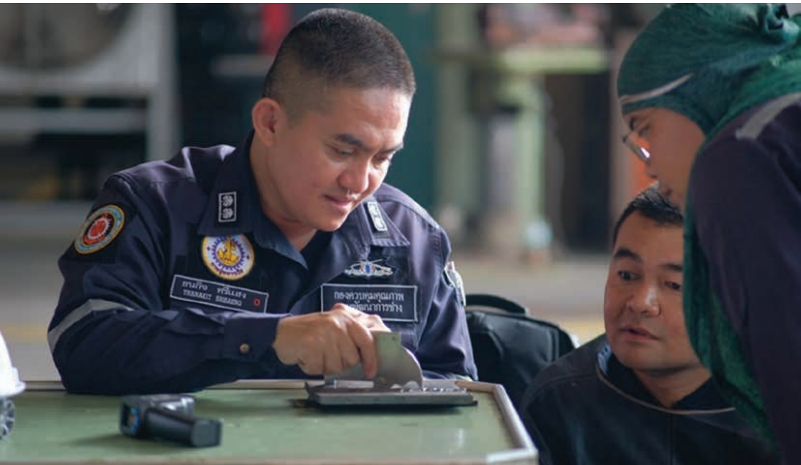
รูปการตรวจสอบชิ้นงานสำหรับการทดสอบฝีมือช่างเชื่อม อร. โดยเกณฑ์การยอมรับเป็นไปตามมาตรฐาน AWS D1.1
