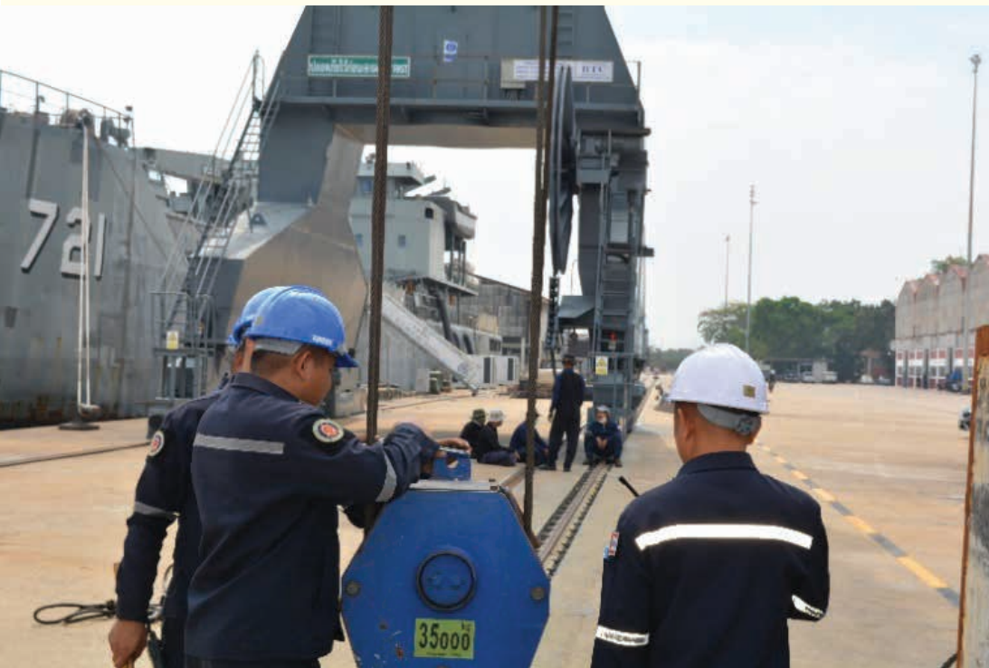
รูปที่ 21 การตรวจสอบปั้นจั่นอุทธารเรือพระจุลจอมเกล้า
