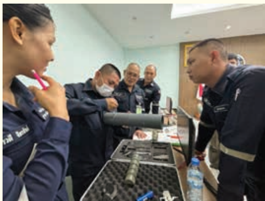
รูปการเรียนการตรวจสอบแบบไม่ทำลายโดยวิธีพินิจ (VT) โดยฝึกการตรวจด้วยชิ้นงานตัวอย่าง
