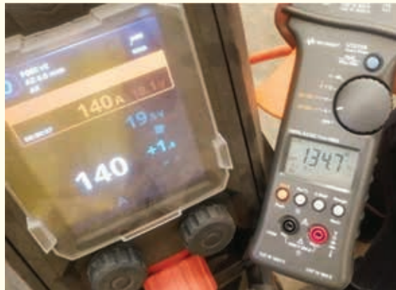
รูปการวัดค่ากระแสไฟฟ้าของเครื่องเชื่อม ขณะทำการเชื่อม และ เอกสารบันทึกค่าสำหรับเครื่องเชื่อม
