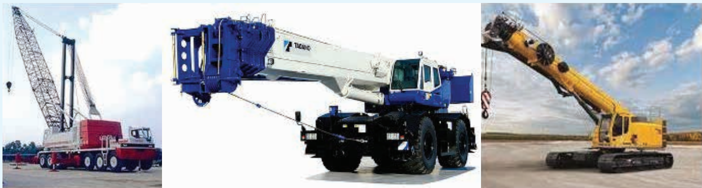
รูปที่ 2 แสดงปั้นจั่นชนิดเคลื่อนที่ Crawler Mounted Variable Boom Wheel Mounted Fixed Boom และ Rough Terrain Crane ตามลำดับ
