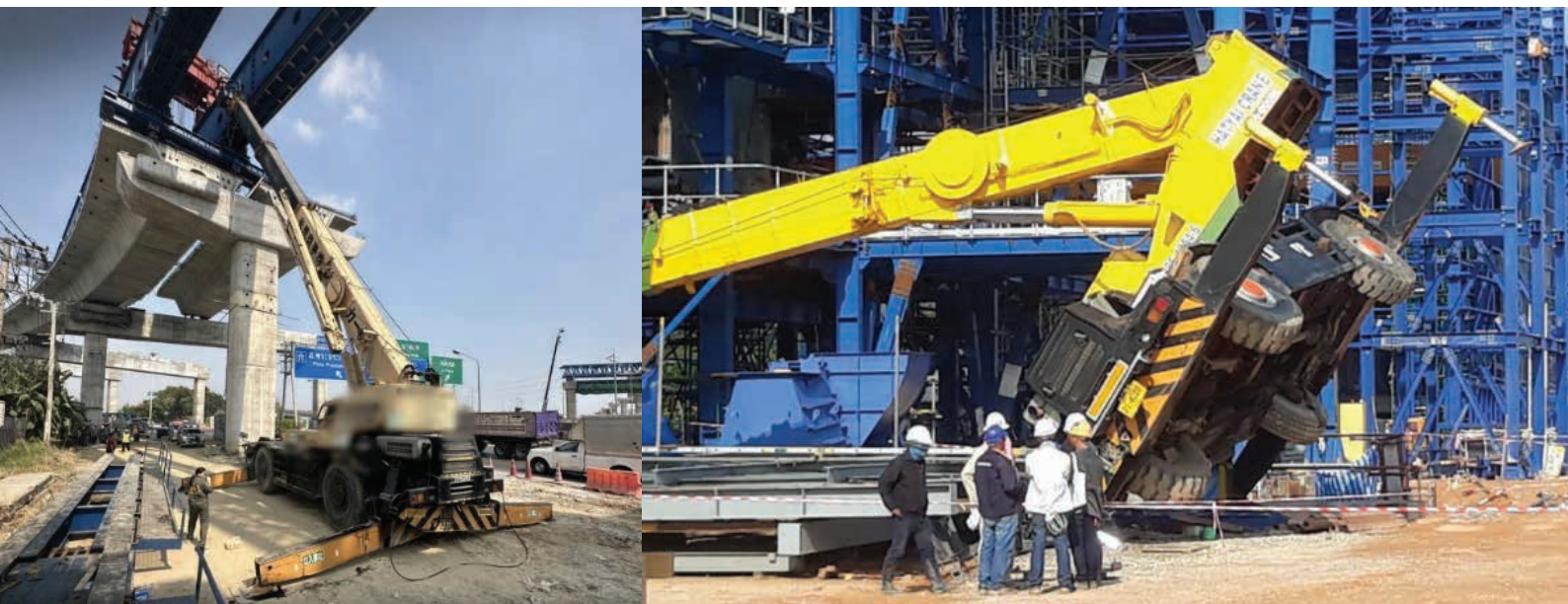
รูปที่ 8 แสดงภาพอุบัติเหตุปั้นจั่นชนิดเคลื่อนที่ที่เกิดขึ้นในประเทศไทย ลวดสลิงชุดยกดขาดและปั้นจั่นยกน้ำหนักเกินพิกัด
