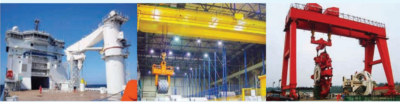
รูปที่ 1 แสดงปั้นจั่นชนิดอยู่กับที่ Jib Crane Overhead Crane และ Gantry Crane ตามลำดับ
