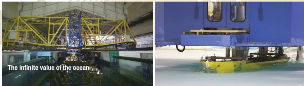
รูปที่ 4 ก) Towing Tank รันเวอร์ยาวถึง 300 เมตร สำหรับทดสอบหาแรงต้านทานการเคลื่อนที่ของแบบจำลองเรือ
