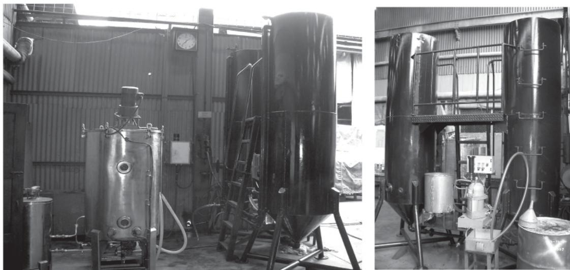
ระบบผลิตใบโอดีเซลแบบ Semi-Continuous Batch Process ในปัจจุบันมีกำลังการผลิตน้ำมันใบโอดีเซลได้ถึง 2,000 ลิตรต่อวัน
