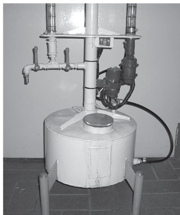
ระบบผลิตใบโอดีเซลแบบต่อเนื่อง เป็นระบบผลิตใบโอดีเซลที่ใช้หลักการ การผสมแบบปั่นป่วน (Oscillatory mixing) ทำให้การดำเนินการดำเนินไปอย่างรวดเร็วและต่อเนื่อง ทำให้มีคักษะภาพในการผลิตน้ำมันได้ สูงกว่า ระบบ Batch ที่ใช้ในปัจจุบัน ระบบนี้ยังอยู่ในขั้นตอนการวิจัยและได้รับงบประมาณจากสำนักงานวิจัยและพัฒนาการทหารก้าวใหม่แล้ว
