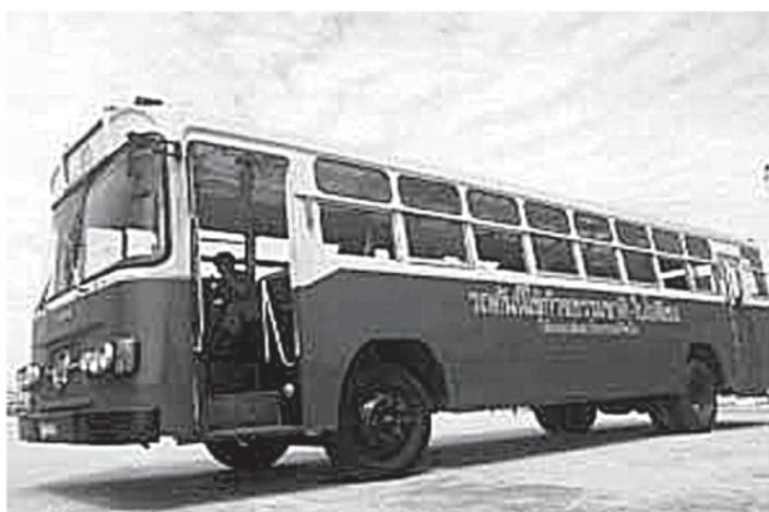
การใช้ก๊าซธรรมชาติร่วมกับไบโอดีเซลในเครื่องยนต์ดีเซล ยังช่วยในการลดมลภาวะที่เกิดจาก เครื่องยนต์ดีเซล โดยเฉพาะคันด้านเป็นที่น่ารำคาญ และส่งผลกระทบต่อสุขภาพประชาชน เครื่องยนต์ ดีเซลที่ก่อให้เพิ่ดด้วยในโครงการนี้สามารถลดคันด้านลงร้อยละ 40 เมื่อเทียบกับเครื่องยนต์ที่ใช้น้ำมัน ดีเซลจากปีโตรเลียม
