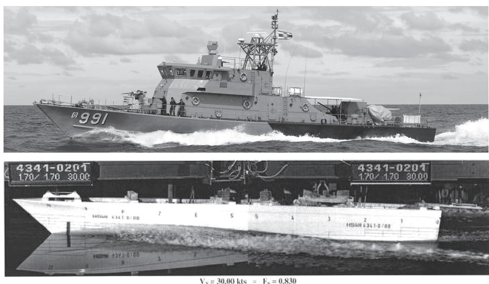
รูปที่ 4 แสดงภาพเรือจำลองขณะทำ Self Propulsion Test ที่ความเร็ว 30 นอต จะสังเกตว่ารูปแบบของคลื่นที่เกิดจากหัวเรือมี Wave Pattern ที่ดี เปรียบเทียบกับเรือจริง
