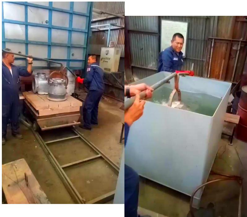
รูปที่ ๑๕ การอบชุบงานความร้อน (heat treatment) ชิ้นส่วนอุปกรณ์ของระบบ Waterjet
