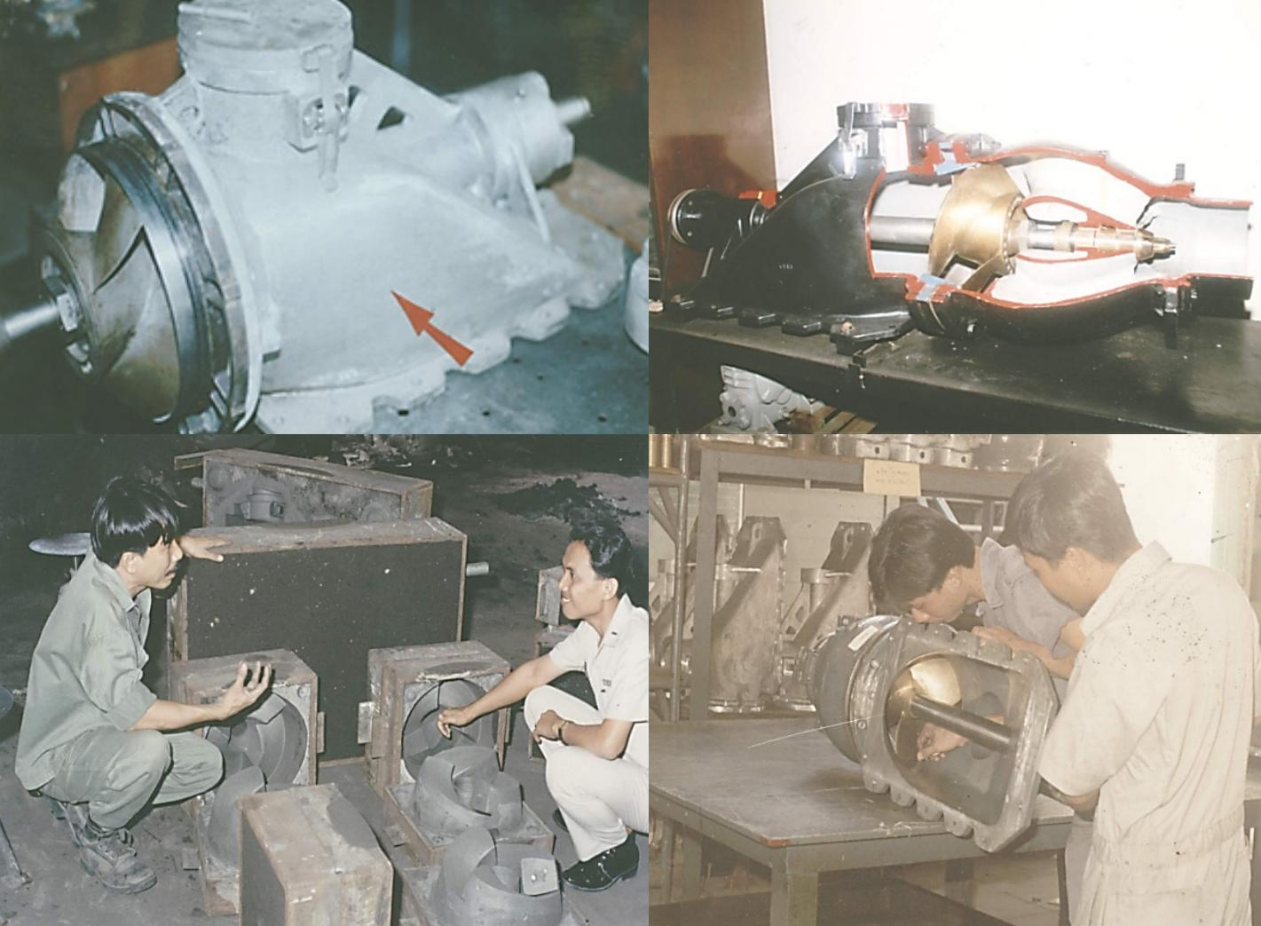
รูปที่ ๑๐ กระบวนการวิเคราะห์และซ่อมแซมเครื่องพ่นน้ำ Marine Jet รุ่น ๑๔ YJ โดย กรมอู่การเรือ
