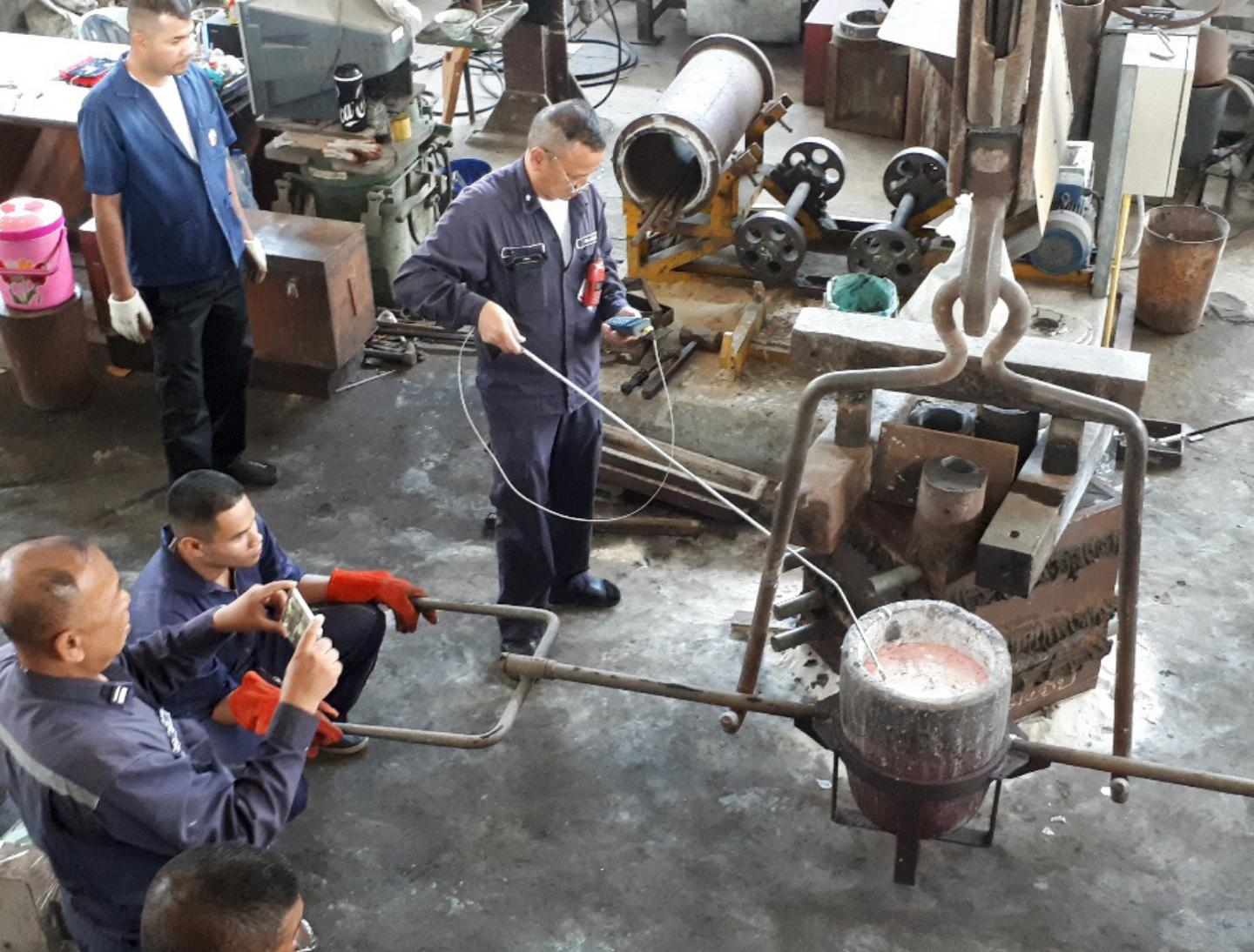
รูปที่ ๑๕ กระบวนการเทกล่อชิ้นงานอุบลเป็นของเชื้อส่วนระบบ Waterjet
