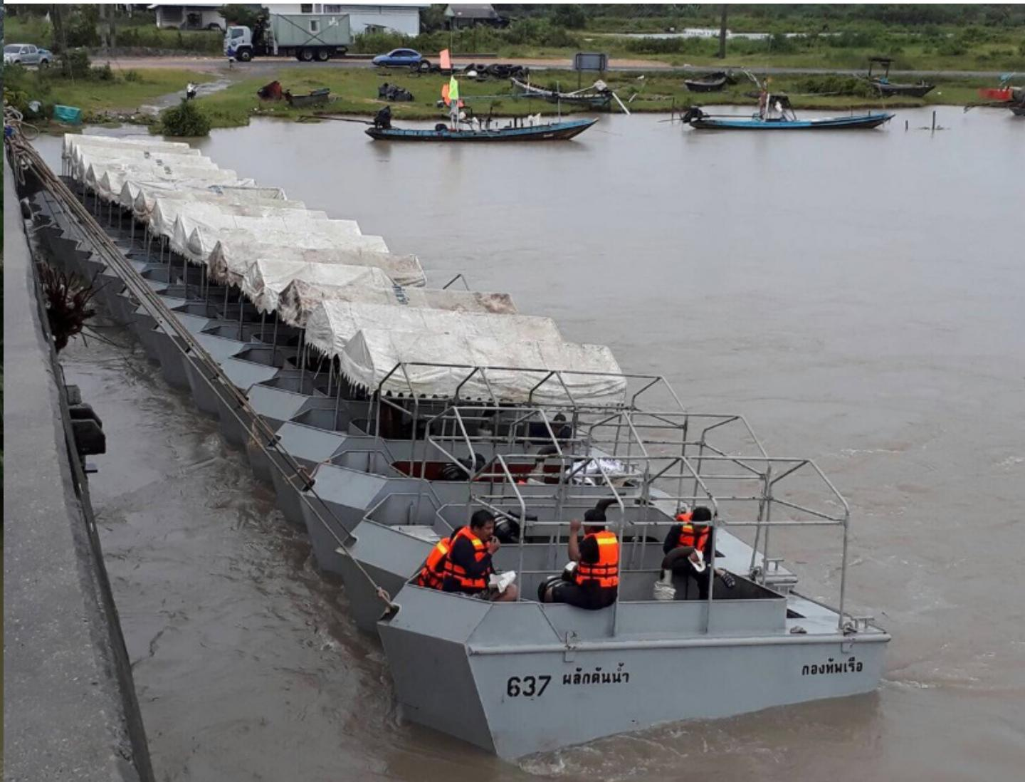
รูปที่ ๔ การนำ Waterjet มาประยุกต์ใช้กับเรือพลักดันน้ำ
