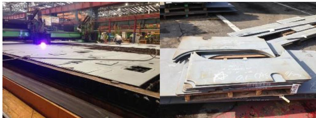
รูปที่ ๓.๕ การตัด (Cutting) ส่วนประกอบย่อยตามเส้นลายแบบ (Mold line)
