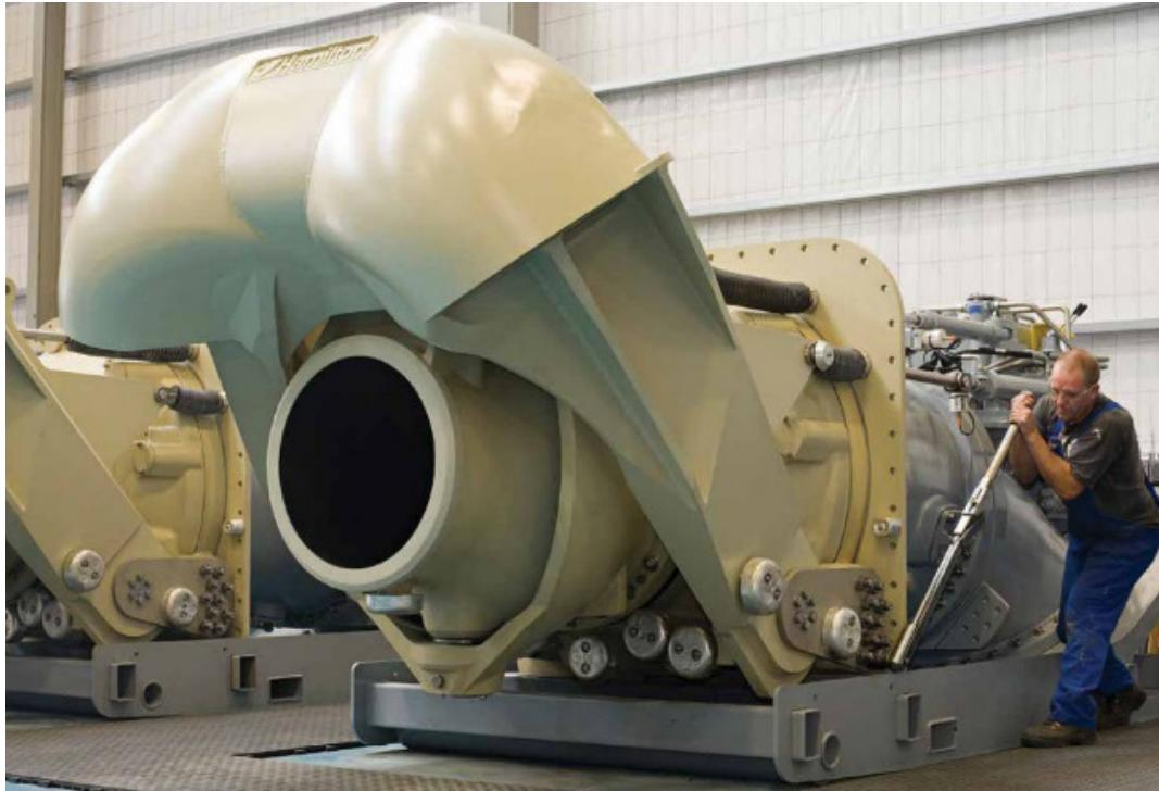
รูปที่ ๑ SHIP WATER-JET DRIVE รุ่น HT3000<sup>®</sup>
