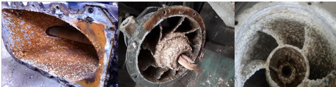
รูปที่ ๑๒ ลักษณะการสึกหรอของส่วนประกอบระบบปั๊กเคลื่อนแบบ Waterjet
