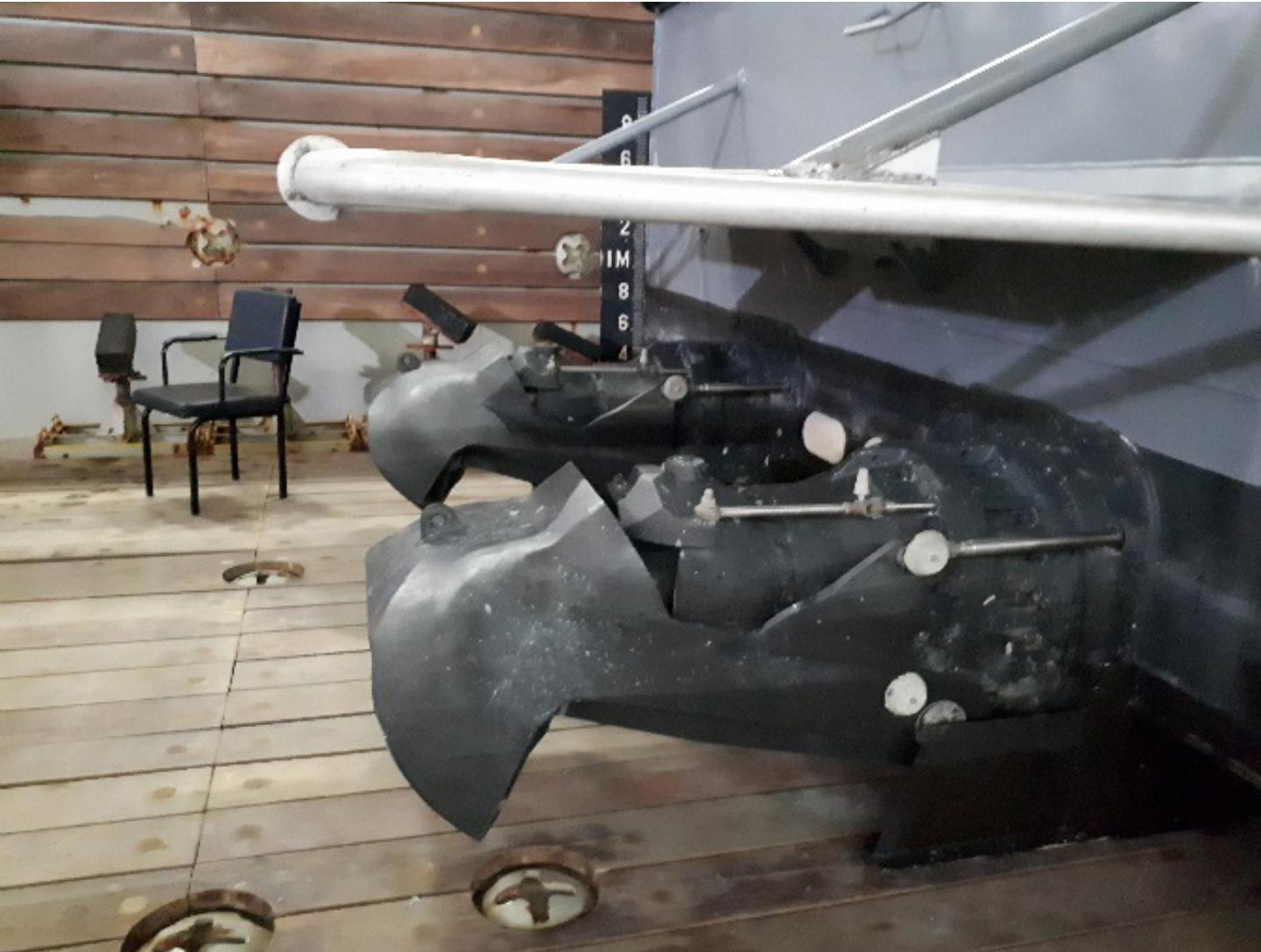
รูปที่ ๓/ ระบบยับกอกสี่อน Waterjet ที่ใช้ในเรือ LCM ของเรือหอดวงจั่งกอง
