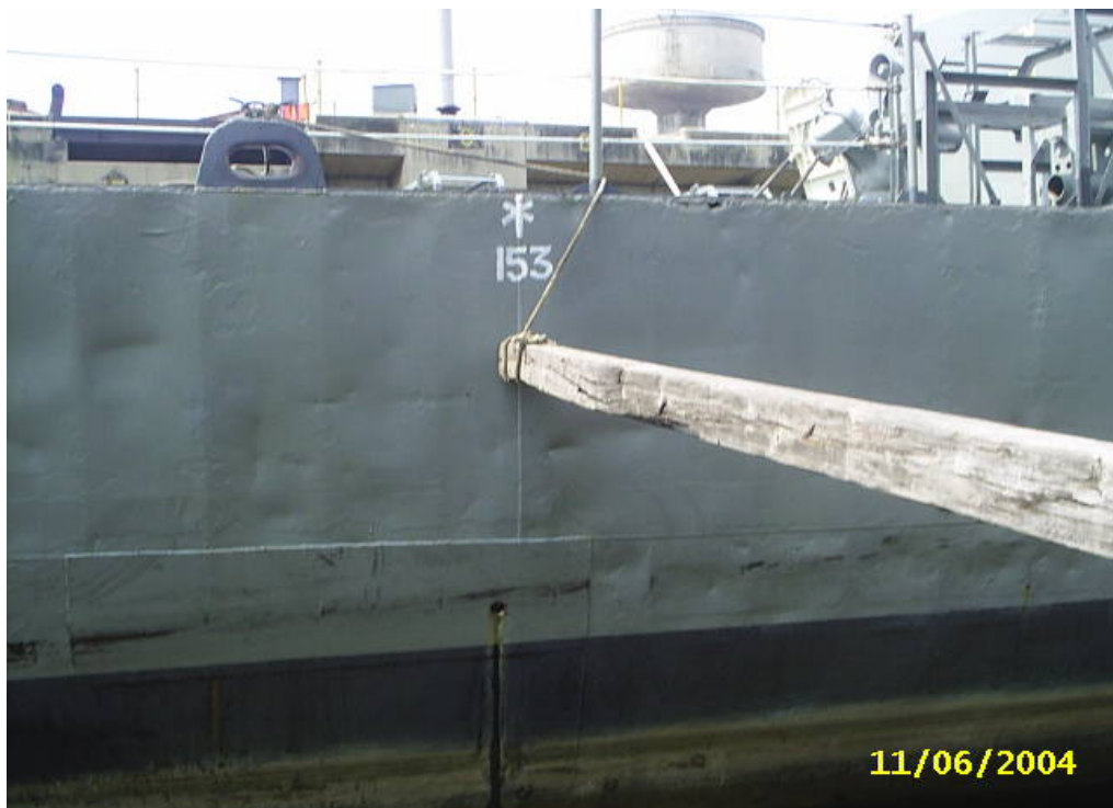
การติดตั้งไม้ค้ำยัน
