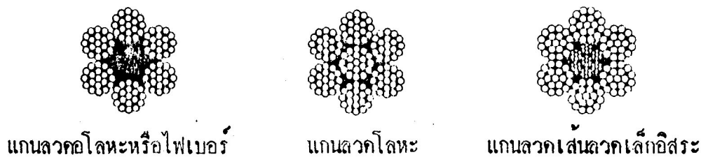
รูปที่ 2 แสดงชนิดของแกนสลาด 3 แบบ
